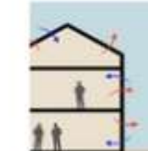
EDIFICI SENSE AÏLLAMENT TÈRMIC
